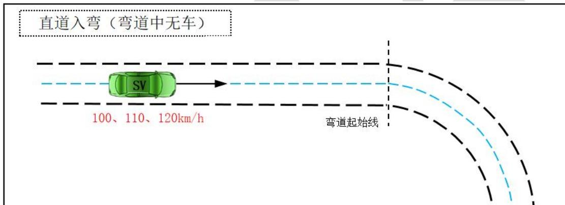
图 17 直道入弯（弯道中无车）场景示意图
