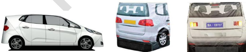
图6 乘用车柔性目标物外观（3D 整车目标物、不带灯光系统、带灯光系统）
