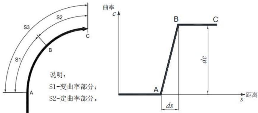
图5 弯道曲率示意图
