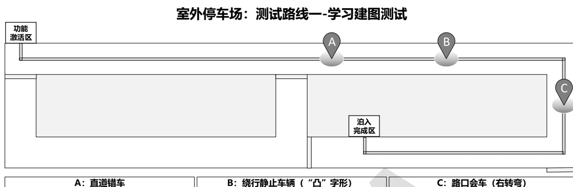
图 A. 23 室外停车场测试路线一学习建图测试场景设置示意图
