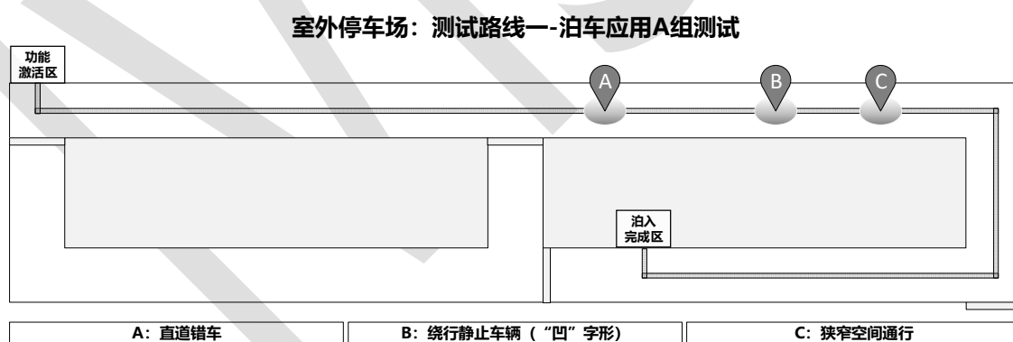
图 A. 24 室外停车场测试路线一泊车应用 A 组测试场景设置示意图
