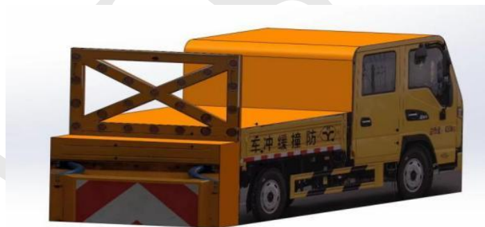
图 3 防撞缓冲车目标物外观
