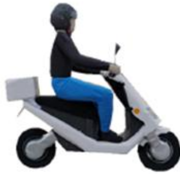
图 14 踏板车骑行者目标物 STA 外观示意图
