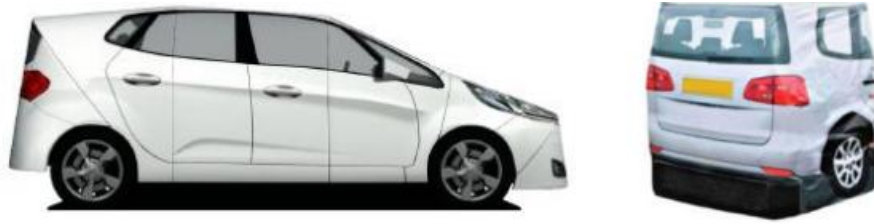
图 5 试验目标物-乘用车柔性目标物外观示意图
