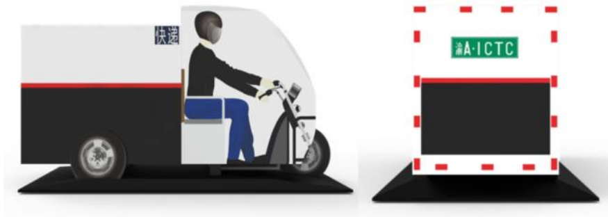
图 7 快递三轮车柔性目标物外观
