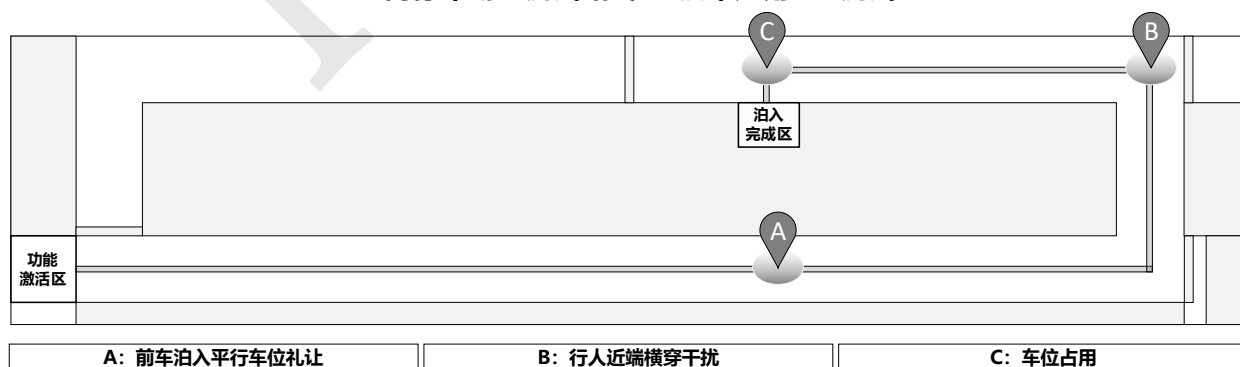
图A. 15 室内停车场测试路线二泊车应用 A 组测试场景设置示意图
