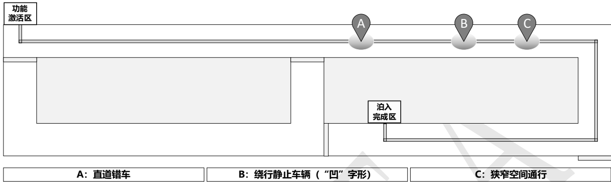
图A. 24 室外停车场测试路线一泊车应用 A 组测试场景设置示意图
