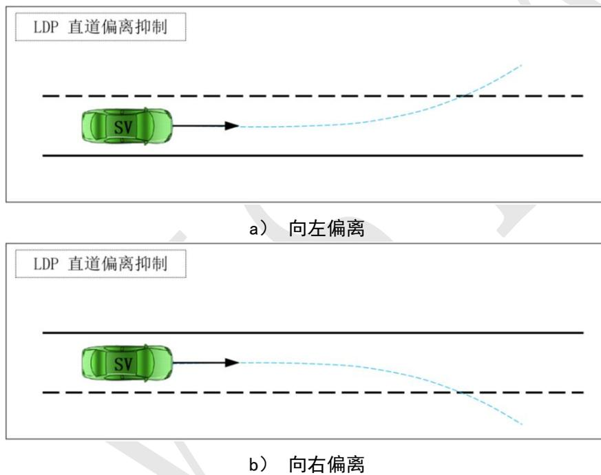
图 1 LDP 直道偏离抑制试验方法
