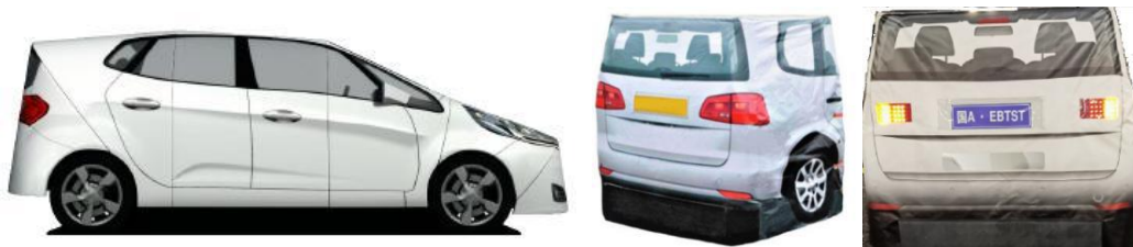
图 5 乘用车柔性目标物外观（3D 整车目标物（左）、不带灯光系统（中）、带灯光系统（右））
